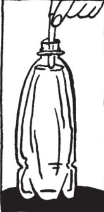
4. Füll nun die große Plastikflasche mit Wasser, sie muss fast bis zum Rand gefüllt sein. Nimm das Glasröhrchen aus dem Glas und gib es mit der Öffnung nach unten in die Plastikflasche.
